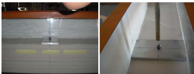
Figura 2. Sapata de fundação
